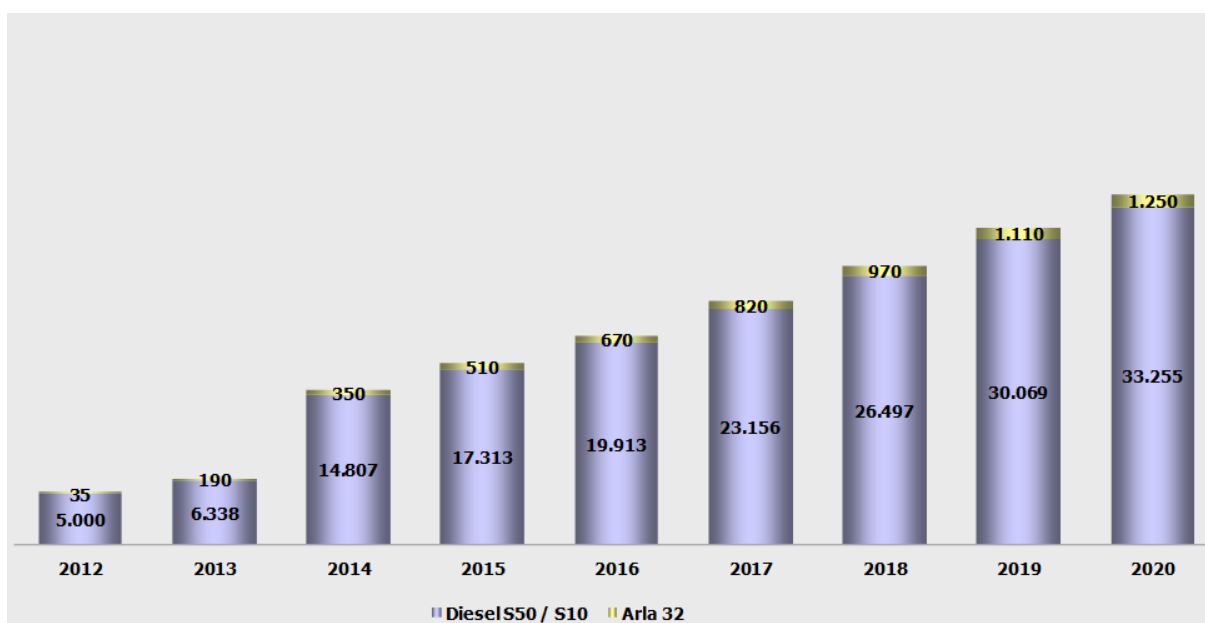
Figura 6 - Demanda de Arla 32 (mil m³) X Diesel S50 e S10 (milhões m³) Fonte: EPE (Empresa de Pesquisa e Energia; “A”), 2012 – adaptado
