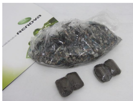
Figura 2 - Massa flocada utilizada na indústria cimenteira Fonte: Acervo da empresa Bituca Verde.
